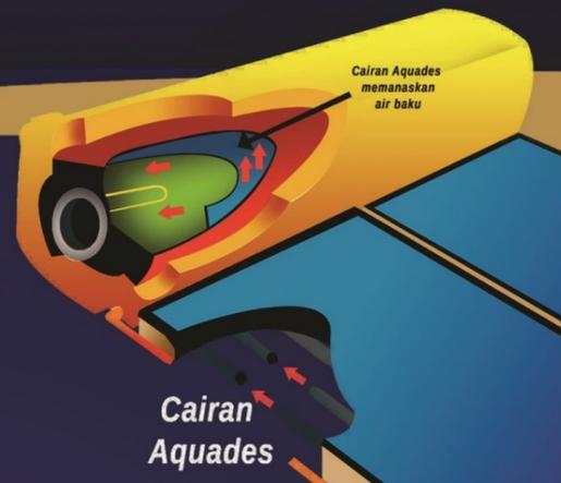
Sistem kerja pemanasan air Solahart Indirect Series tidak secara langsung, air didalam tangki dipanaskan oleh media pemanas, media tersebut bersirkulasi (*thermosiphon*) pd jacket tank (*closed circuit*). Disaat melalui jacket tank media pemanas tsb memanaskan air yg disimpan dalam tangki air panas yang akan digunakan keluarga anda.
