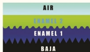
2 lapis Vitreous Enamel membuat tangki tahan tekanan 10 bar & anti karat, sehingga usia tangki sangat panjang.
